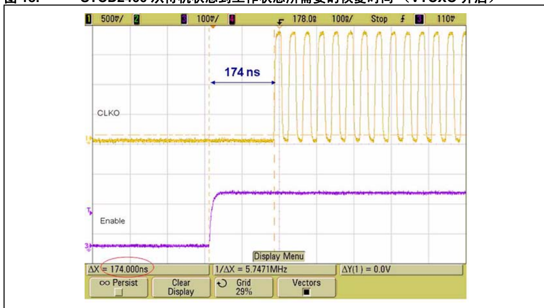
图 19. STCD2400 从关闭到开启所需的恢复时间 (VTCXO 先处于待机状态)
